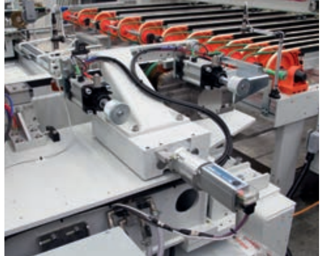
Die automatische Regelung der Vorauslinie zum Abtragen entsprechend der Stärke vermeidet ein manuelles Eingreifen des Bedieners.
