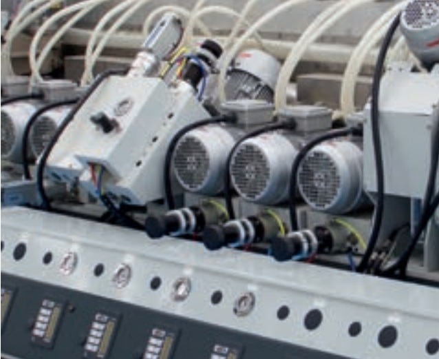
Die Proportionalventile zur automatischen Steuerung des Drucks der Polierwerkzeuge entsprechend der Plattenstärke verkürzen die Setup-Zeiten der Maschine erheblich.
